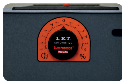
Bewegliche Projektionsfläche (MPS) mit Drehknopf und Skala
